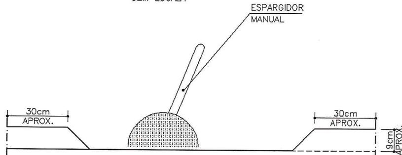
IMPRIMAÇÃO DA SUPERFÍCIE OBTIDA APÓS A REMOÇÃO DO MATERIAL E LIMPEZA DAS FACES DA ESCAVAÇÃO ATÉ APROXIMADOS 30cm ALÉM DAS BORDAS.
