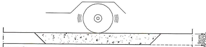
EXECUÇÃO DO REVESTIMENTO (C.B.U.Q. - FAIXA "C") E COMPRESSÃO COM ROLO PNEUMÁTICO E/OU ROLO METÁLICO LISO.
